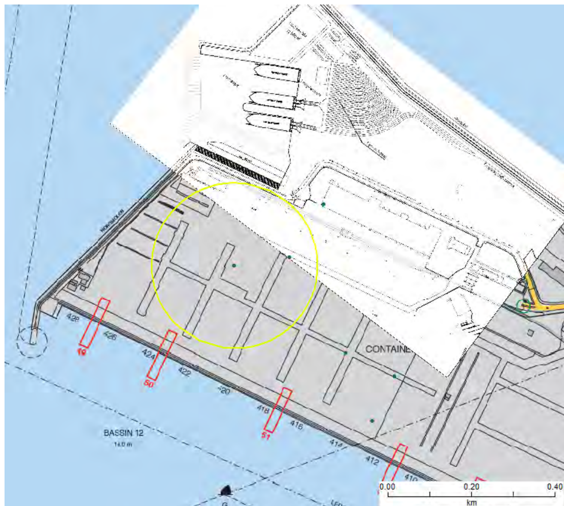
Figur 5-15 Oversigtsplot med konsekvensafstand for varmestrålingen fra en BLEVE (17 kW/m 2 svarende til 20 sekunders eksponering) ved eksplosion af et propanudslip ved lastningsområdet.
