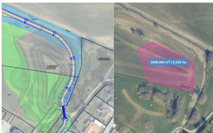
Figur 2: Billedet til venstre viser det planlagte bassin, mens billedet til højre viser det areal, der ønskes erhvervet til udvidelsen af bassinet (arealet er omtrentligt).
