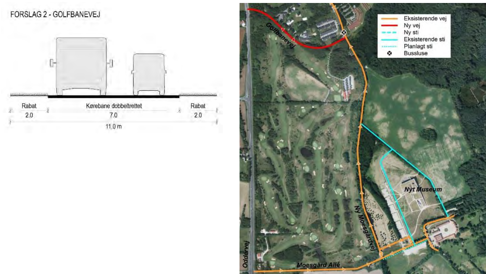
Figur 3-3 Principielt tværprofil for den nye Golfbanevej i Forslag 2 - samt principskitse.
