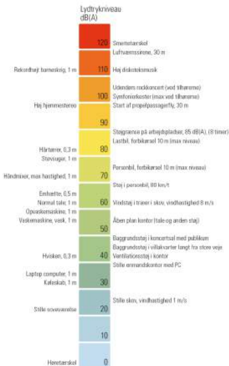
Figur 18-1. Illustration af typiske støjniveauer for forskellige støjklender. Man skal være opmærksom på, at støjen fra en støjkilde falder, når man bevæger sig ud på større afstand. Kilde: Force Technology.
